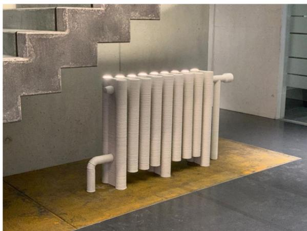
Der in 3D-Betondruck realisierte Deko-Radiator ist ein Eye-Catcher im Eingangsbereich von Hopferwieser + Steinmayr.
